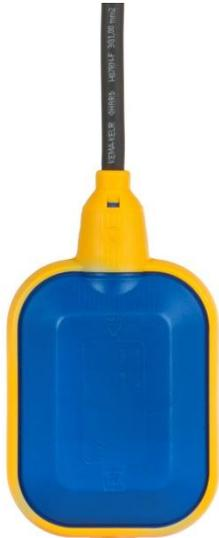
Der Niveauregler KR 1 eignet sich vor allem zur einfachen und sicheren Steuerung von Entwässerungspumpen, wobei je nach Kabellänge die Differenz zwischen dem Ein- und Ausschalt- punkt bestimmt werden kann. Im Gegensatz zu anderen Reglern ist beim Typ KR 1 zum Ein- und Ausschalten jeweils nur 1 Regler erforderlich. Der **KR 1 U** ist mit einem Umschalter ausgerüstet. Der Niveauregler kann sowohl zum Füllen wie auch zum Entleeren eingesetzt werden.
